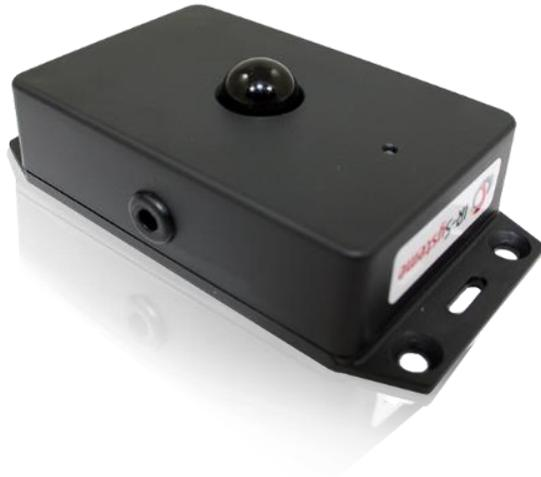
Der Infrarot Sensor ist kompatibel mit den Systemen aus der IFFS Serie. Angeschlossen an eine Control Unit empfängt der Sensor trägerbasierte Infrarot-Telegramme von den Handsendern aus der Serie, wertet die Telegramme aus und schickt die Steuerdaten an die Control Unit. Der IR Sensor bietet eine umgebungslichtabhängige Verstärkung, d.h. die Reichweite ist abhängig von der Umgebungshelligkeit. Die Länge der Anschlussleitung beträgt ca. 80 cm.
